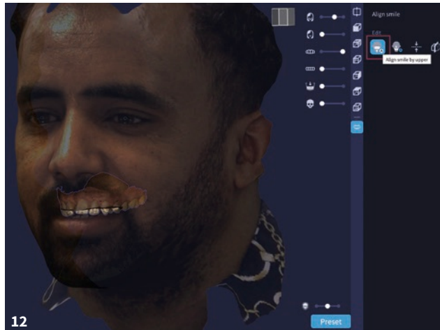
Abb. 12 Die Bildschirmseite „Align Smile“ ermöglicht das Autoalignment der bereits fusionierten Gesichtsscans mit Zahnschans.
