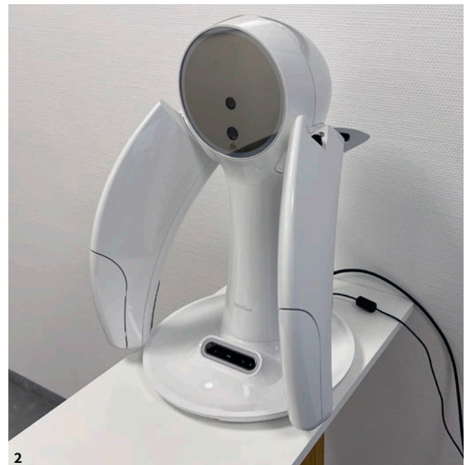
Abb. 1 Der Gesichtsscanner RAYFace 200 mit angedocktem Kalibrierkörper macht einen hochwertigen und soliden Eindruck. Die Kalibrierung dauert nur knapp drei Minuten, die Autoren empfehlen daher, sie täglich durchzuführen. Abb. 2 Auch wenn es sich bei dem RAYFace um ein stationäres System handelt, lassen sich die Arme nach Lösen einer Verriegelung zum einfacheren Transport anlegen.
