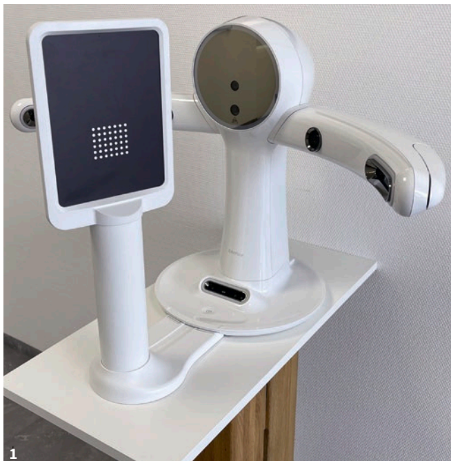
Abb. 1 Der Gesichtsscanner RAYFace 200 mit angedocktem Kalibrierkörper macht einen hochwertigen und soliden Eindruck. Die Kalibrierung dauert nur knapp drei Minuten, die Autoren empfehlen daher, sie täglich durchzuführen. Abb. 2 Auch wenn es sich bei dem RAYFace um ein stationäres System handelt, lassen sich die Arme nach Lösen einer Verriegelung zum einfacheren Transport anlegen.
